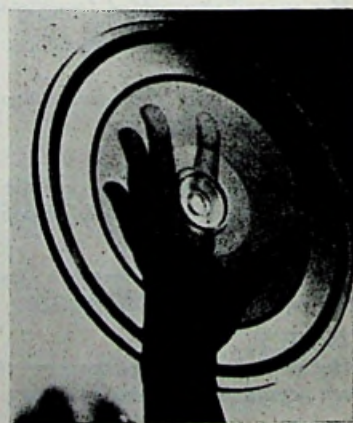
Figuur 2. Geheugen (dictionaire) van de vertaalmachine. Langs de rand van de schijf ziet men de emulsieband.
